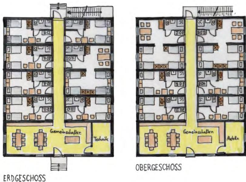
Abbildung 25: Beispielgrundriss (EG/OG) für Übergangswohnanlage 2: Mehrbettzimmer mit eigener Nasszelle / Kochstelle
