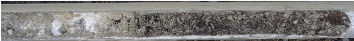
Bild 3: Schlacke-Auffüllung in der Bohrsonde (RKS 4)
